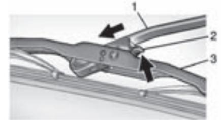
2. Empuje la palanca de liberación (2) para desacoplar el gancho y empuje el brazo del limpiador (1) hacia fuera del ensamble de la pluma (3).
