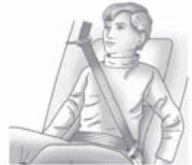
4. Abroche, coloque y libere el cinturón de seguridad como se describe previamente en esta sección. Asegúrese que la porción del hombro del cinturón esté sobre el hombro y no caiga
