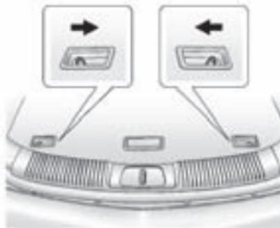
2. Empuje las palancas del piso de carga.
