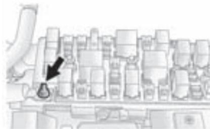
Su vehículo está equipado con una terminal positiva (+) remota. Esta está ubicada dentro del compartimiento del motor, del lado del conductor del vehículo, en el bloque de fusibles bajo el cofre. Para mayor información sobre la ubicación, vea *Vista general del compartimiento del motor en la página 10-5*.
