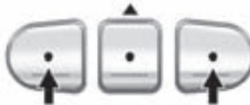
1. Pulse sin soltar los dos botones exteriores hasta que la luz indicadora comience a parpadear, después de 20 segundos.
