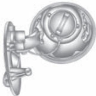
El tapón de combustible está ubicado detrás de la puerta abatible para el tanque de combustible, en el lado del conductor del vehículo. Si está equipado, la puerta de combustible está bloqueada cuando las puertas del vehículo están cerradas. Presione
