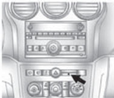
La luz de seguridad está cerca del centro del tablero de instrumentos.
