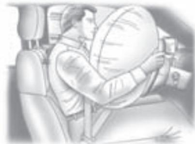
La bolsa de aire frontal del conductor está en medio del volante de conducción.
