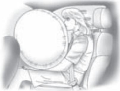
La bolsa de aire delantera del pasajero delantero externo está en el tablero de instrumentos del lado del pasajero.
