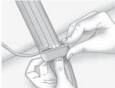
2. Coloque la guía sobre el cinturón e inserte los dos bordes del cinturón dentro de las ranuras de la guía.
