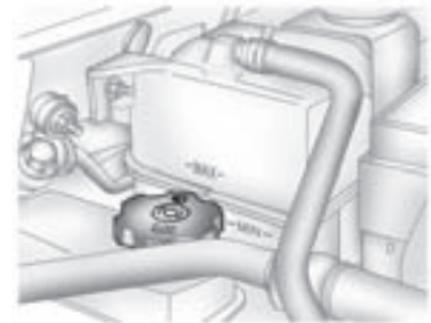
3. Llene el tanque de compensación del refrigerante con la mezcla de refrigerante DEX-COOL adecuada, entre las líneas MIN (mínimo) y MAX (máximo).
