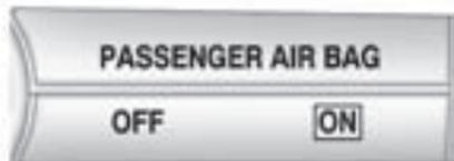
Cuando se arranca el vehículo, el indicador de estado de la bolsa de aire del pasajero se encenderá mostrando las palabras ON (Activo) y OFF (Inactivo), durante varios segundos a modo de revisión al sistema. Entonces, después de varios segundos, el indicador de
