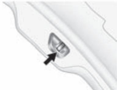
Para abrir la puerta trasera, si la batería del vehículo está desconectada o el voltaje está bajo, abra con la palanca de liberación. Desmonte la cubierta de tapiz interna que está al interior de la puerta trasera. Con una herramienta, empuje la palanca del seguro hasta que se libere la puerta trasera.
