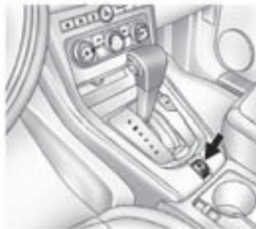
El vehículo cuenta con un Freno de estacionamiento eléctrico (EPB). El interruptor para el EPB se encuentra en la consola central. El EPB siempre puede activarse, incluso con la ignición en la posición OFF. Para prevenir la descarga de la batería, evite ciclos repetidos del sistema EPB cuando el motor está apagado.
