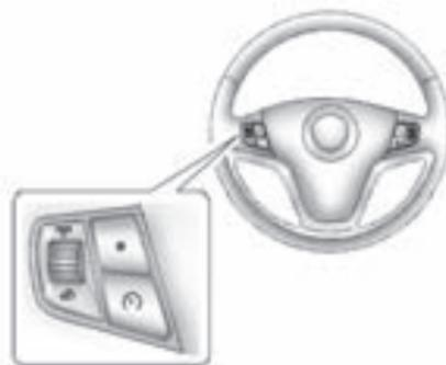
**(encendido/apagado):** Oprima para encender o apagar el control de crucero. La luz indicadora en el botón se enciende o apaga.
