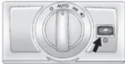
Mueva el mando giratorio hacia la derecha o izquierda para aumentar o disminuir el brillo de las luces del tablero de instrumentos.
