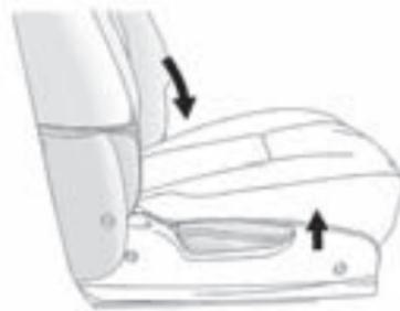
3. Eleve la palanca completamente y pliegue el respaldo hacia adelante hasta que se libere.
