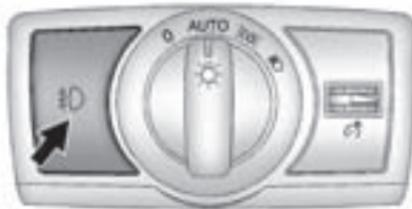
Para los vehículos que cuentan con luces de niebla, el botón está en el tablero de instrumentos junto al control de luz exterior.
