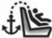
Para ayudar a ubicar los anclajes de correa superior, el símbolo del anclaje de correa superior está cerca de los anclajes de la correa superior.
