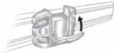
Los adaptadores se utilizan para sujetar la red. Deslice los adaptadores a la ubicación deseada en el riel superior e inferior y gire la
