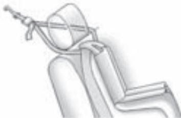
Si la posición que usa tiene una reposacabezas o soporte de cabeza ajustable y está utilizando una atadura doble, dirija la atadura alrededor del reposacabezas o soporte de cabeza.
