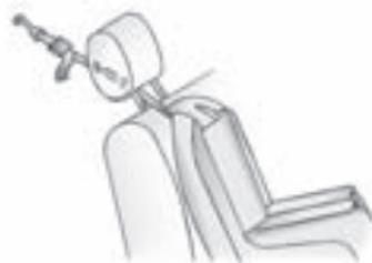
Si la posición que está utilizando tiene un reposacabezas o un soporte de cabeza y está utilizando sólo una atadura, levante el reposacabezas o el soporte de cabeza y pase la correa por debajo del reposacabezas o del soporte de cabeza así
