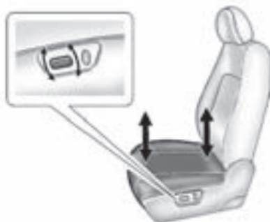
Para subir o bajar la parte delantera o trasera del cojín del asiento, mueva la parte delantera o trasera del control hacia arriba o hacia abajo.
