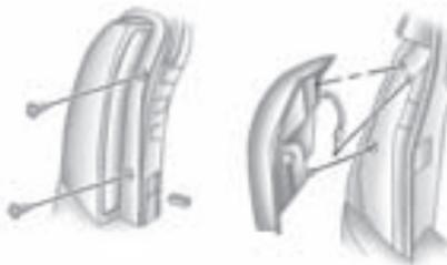
2. Retire los dos tornillos que sujetan al interior del ensamblaje de la luz trasera.
