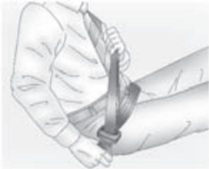
5. Para apretar la parte de la cintura, jale el cinturón de hombro hacia arriba. Puede ser necesario tirar de la costura del cinturón de seguridad a través de la placa del seguro para apretar completamente el cinturón del regazo sobre los ocupantes más pequeños.
