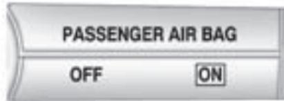
El sistema de sensor del pasajero apagará la bolsa de aire delantera exterior del pasajero bajo ciertas condiciones. Ninguna otra bolsa de aire es afectada por el sistema de detección de pasajeros.
