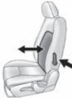
Si está equipado, mueva la palanca hacia adelante o hacia atrás para aumentar o disminuir el ajuste de soporte lumbar.
