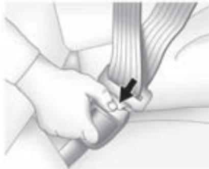
Para desabrochar el cinturón, presione el botón del broche. El cinturón debería regresar a su posición de almacenamiento. Deslice la placa del seguro hacia
