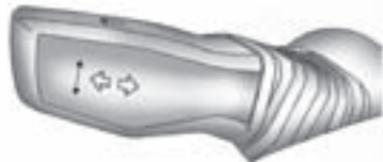
Mueva la palanca completamente hacia arriba o hacia abajo para señalar una vuelta.
